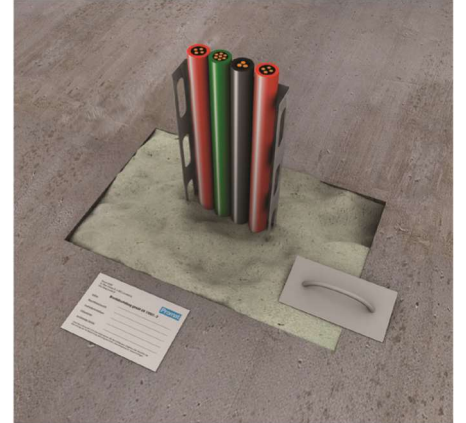
6. Açıklığı düz bir yüzey elde edecek şekilde tesviyeleyin ve bilgi plakasını sabitleyiniz.
