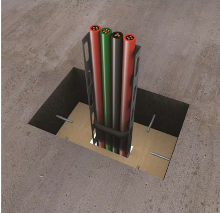
4. Taşyünü plaka, ahşap veya yangına dayanımlı levhalar ile kalıp yapılmalıdır. Promastop-M harç, belirtilen oranlarda su ile karıştırılarak homojen bir karışım elde edilir.
